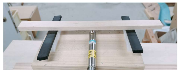
図 2 曲げたわみ振動法
