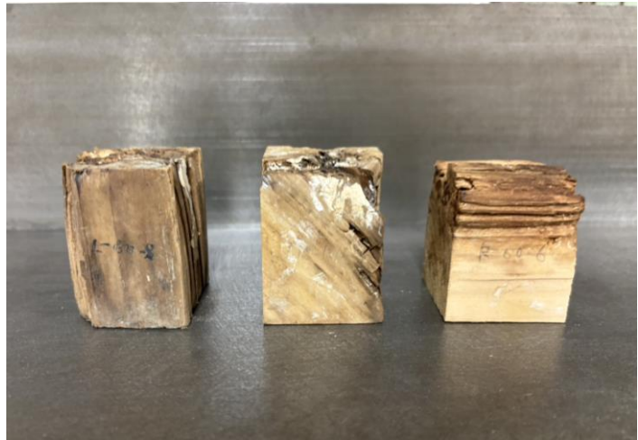
写真 3 腐朽処理後の試験体
