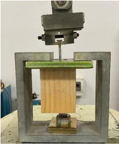
写真 2 引き抜き試験の様子
