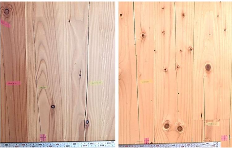
写真5 干割れの例 (左: C, 右: G)
