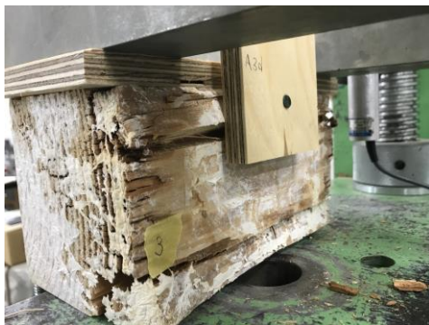
図3. トドマツ腐朽試験体の主材割裂
