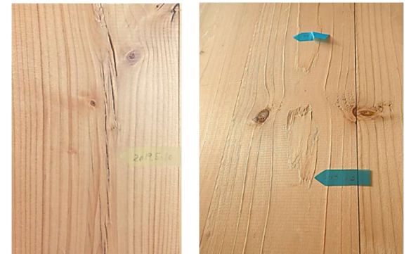
写真7 髓周辺の干割れの例 (J)
