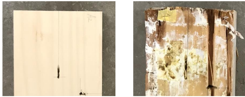
図 5. トドマツ試験体の変形性状
