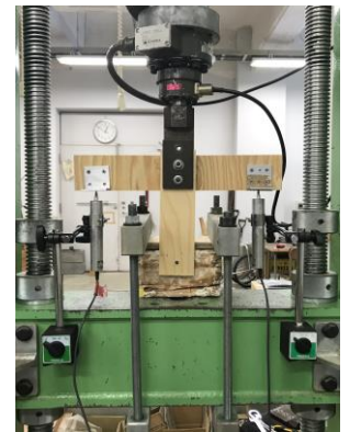
図 1. 繊維直交方向加力試験
