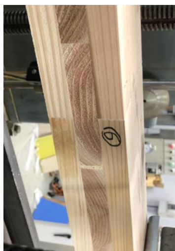
写真 1. 接合形状 バットジョイント
