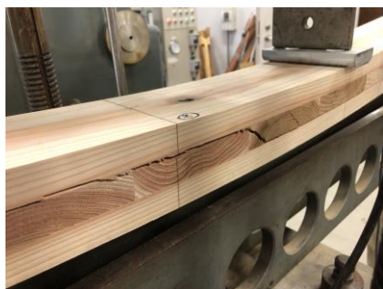
写真4. コントロール 破壊性状
