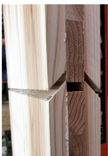
写真 2. 接合形状 スカーフジョイント 1:1
