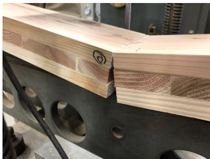
写真5. バットジョイント 破壊性状
