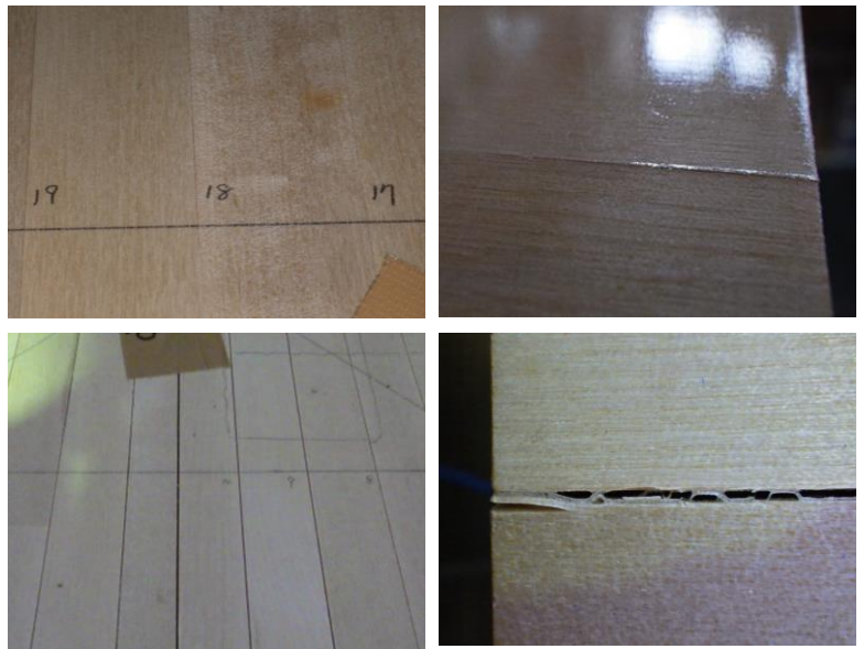
写真2 加湿後および強制乾燥後の試験体
