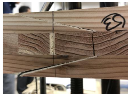
写真6. スカーフジョイント 破壊性状
