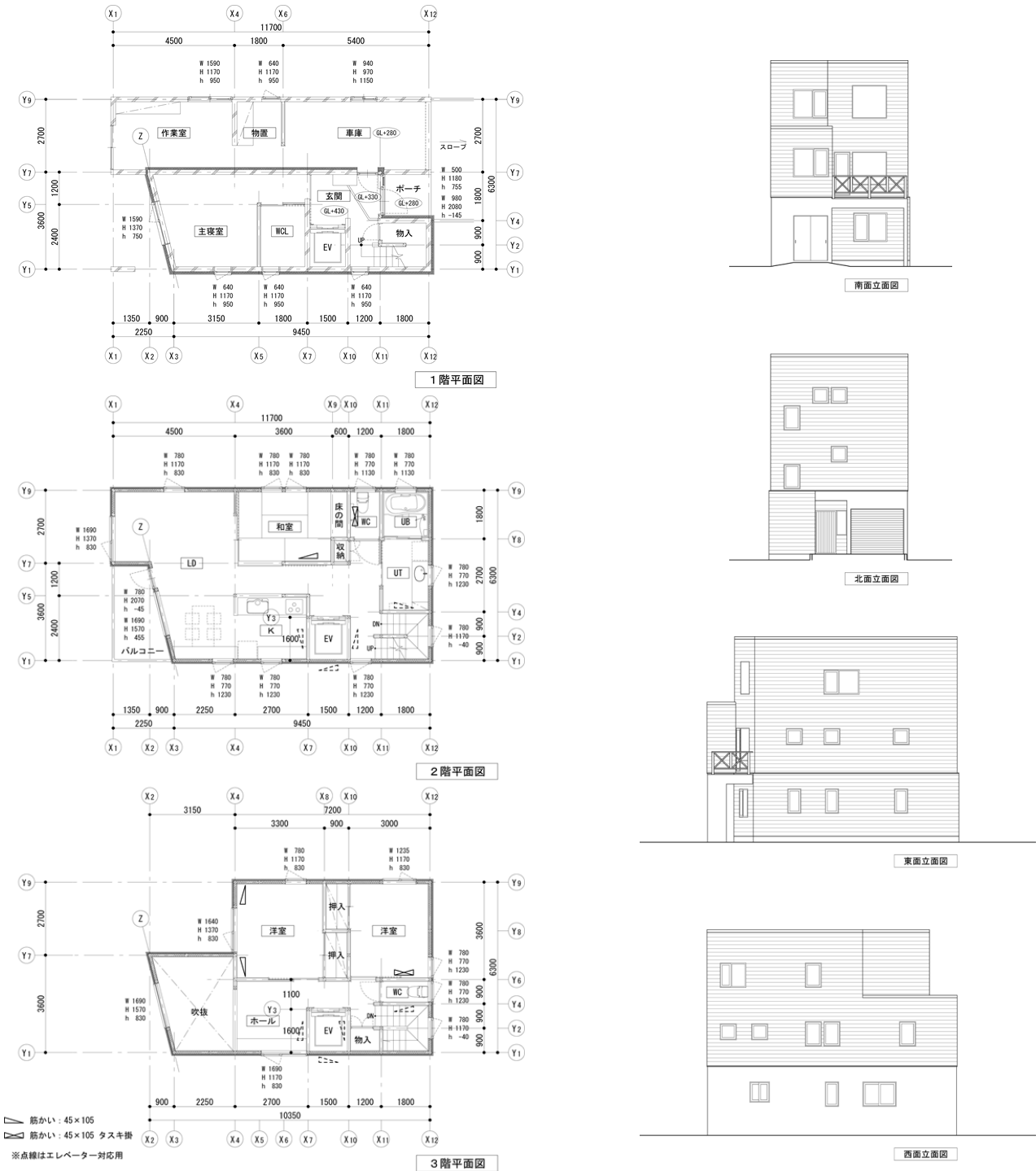
図-1 構造計算例として用いた混構造3階建て（1階RC造、2、3階木造）住宅の平面・立面図
