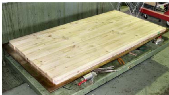
写真3 圧縮用原板のセッティング
