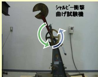
衝撃曲げ破壊試験の仕事
