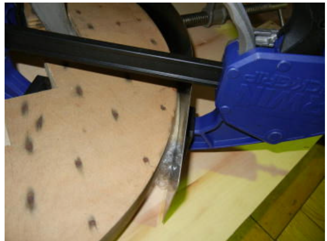
第2図 曲げ加工(曲げ型枠使用)
