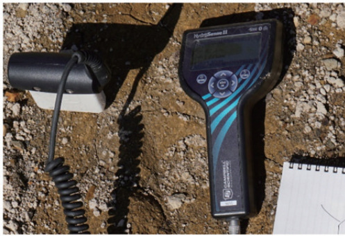
図-15 体積含水率の測定 Fig. 15 Measurement of volumetric water content
