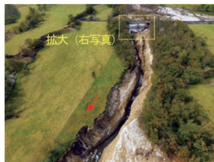
写真-12 3号砂防堰堤損傷状況（UAV による斜め写真）
