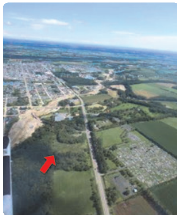
写真-3 ペケレベツ川・清水町市街地における河積の減少による氾濫、蛇行による側岸侵食
