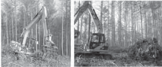
写真-2 残材の収集・搬出(左:グラップルレーキによる残材収集, 右:土そりによる搬出)
