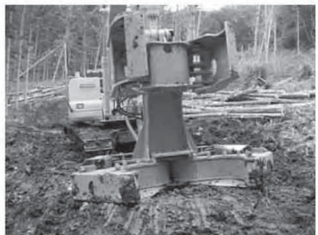
写真-2 供試機に装着された伐倒アタッチメント 上部にグラップル、下部に油圧ハサミ式切断装置
