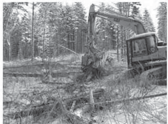
写真-5 供試機によるグラブ作業 切り離れた根株を片付けている状況
