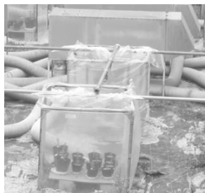
図1 オープントップチャンバーと雨水防止用天蓋 (A 領域紫外線を透過する)
