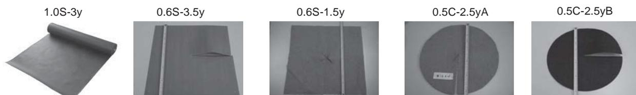
図-1 試験に用いた生分解性防草シート。防草シートの略号は順に、シートの直径または1辺の長さ(単位m)、シートの形(方形;S, 円形;C)、耐用年数(年)を表す。0.5C-2.5yBの表面は特殊加工による飛来種子の着根防止機能を持つ。1.0S-3yは100m×1mのロールで販売されているため、1mの長さに加工して用いた。
