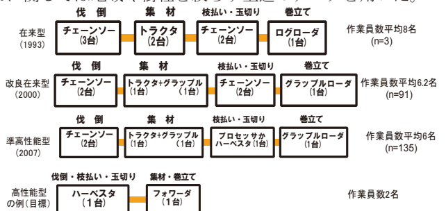
図-4 主な機械作業システムと作業員数
