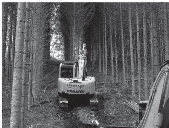
写真-1 ハーベスタによるトドマツ人工林列状間伐作業:1条植栽林分のため元々の列間が広い。ここでは1列の伐採で6mの作業幅が確保された
