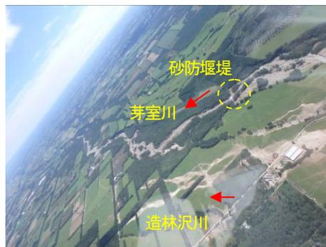
写真 k 砂防堰堤による土石流の捕捉
